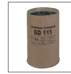
Однокомпонентный герметик без растворителя, обладающий незначительной проницаемостью водяного пара. Предназначен для внутренней (первичной) герметизации многослойных стеклопакетов. Имеет отличное сцепление со стеклом, алюминием, оцинкованной или нержавеющей сталью. Создан на основе синтетического каучука (полизобутилена). Плотность -1,05 кг/дм<sup>3</sup>. Хорошее сопротивление старению. Производство – Германия.
